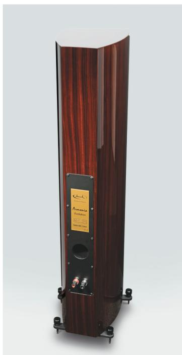
L'arrière a une finesse remarquable. La charge bass-reflex possède un événement dorsal, alors que le bornier en monocâblage est en cuivre pur plaqué argent acceptant fourches et bananes. Les quatre pointes servent à stabiliser l'enceinte, celle invisible du dessous à écouler les vibrations.
